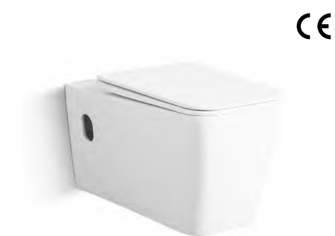
1048W 挂便器 Wall-hung toilet 尺寸 / Size: 570x355x365 mm 墙排 / P-trap, 180mm roughing-in
