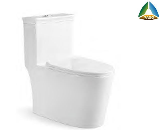
8112 虹吸连体马桶 Siphonic one-piece toilet 尺寸 /Size: 715x420x740 mm 地排 /S-trap, 300/400 mm roughing-in
